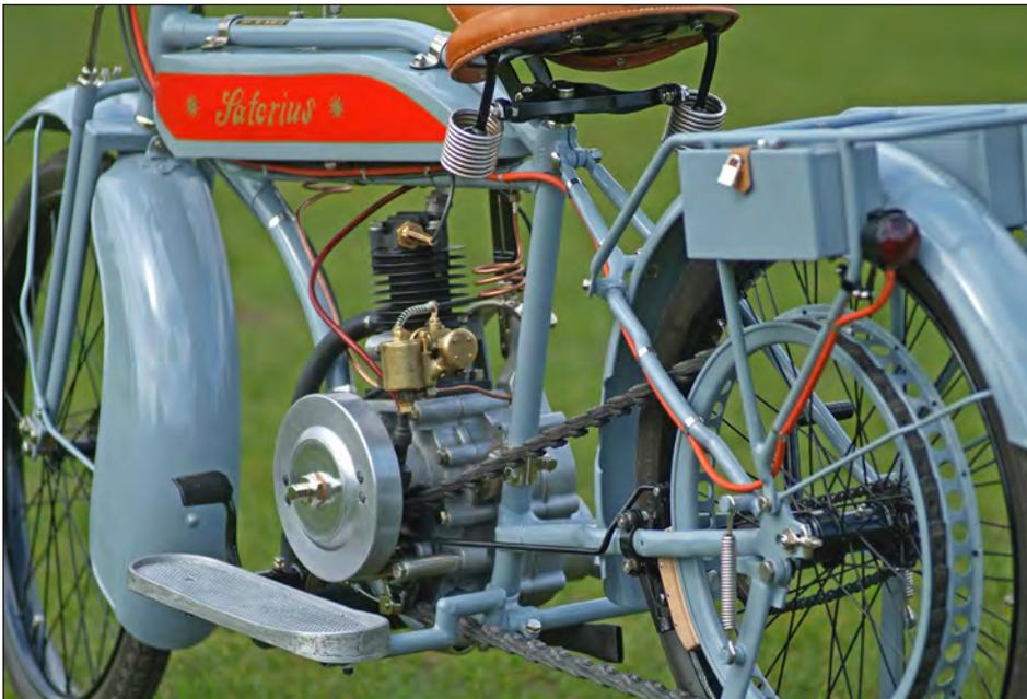
Angetreten wird die Satorius mit einer Kette rechts am Hinterrad. Dann übernimmt ein Riemen den Antrieb.
