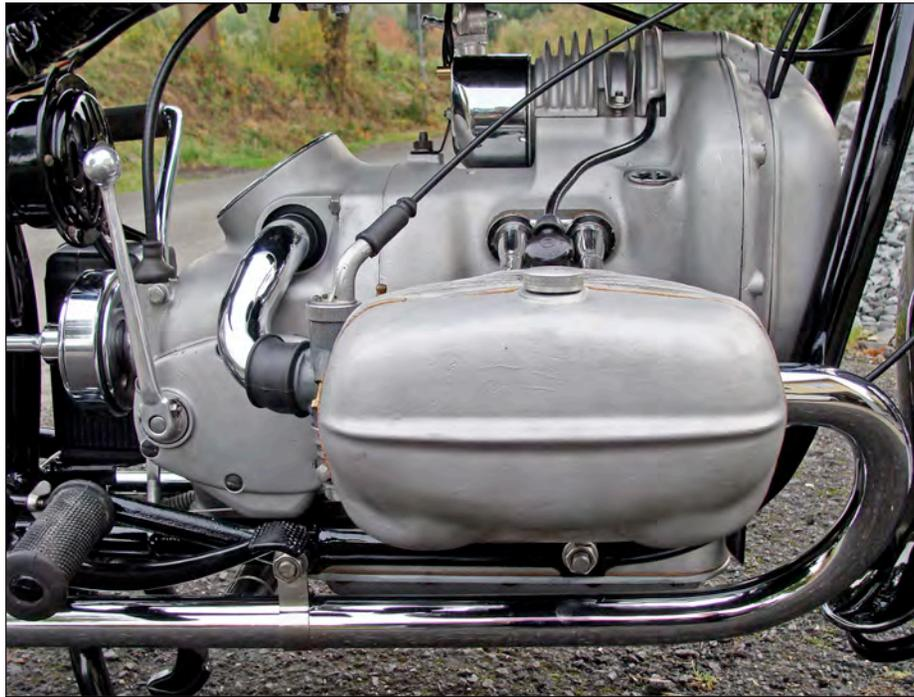
Der Zweizylinder-Boxermotor der BMW R5 hat einen Hub von 68 mm und ebenfalls eine Bohrung von 68 mm. Damit kommt er auf einen Hubraum von exakt 494 ccm.
