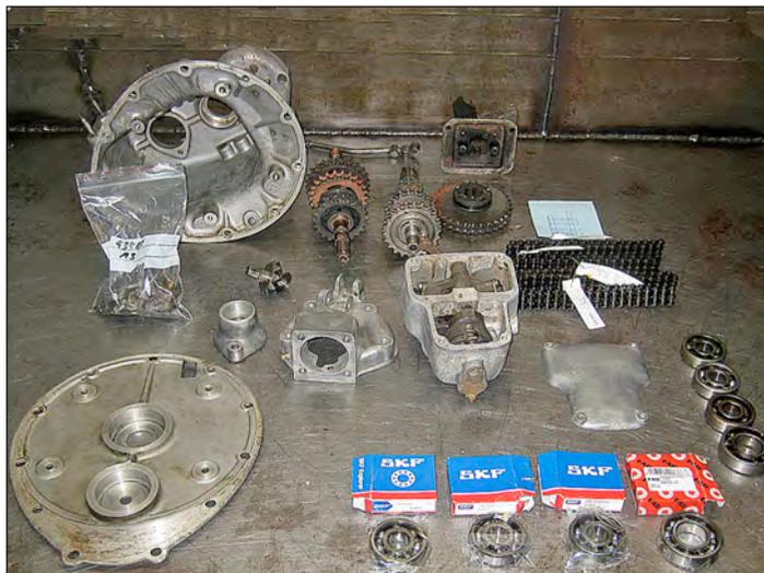
Alle Lager und Dichtungen des Getriebes wurden ausgetauscht.
