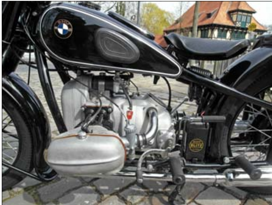
Durch die Boxer-Bauweise sieht der Motor der R66 mit seinen 597 ccm Hubraum gewaltig aus. Fotos: Knut Hornig
