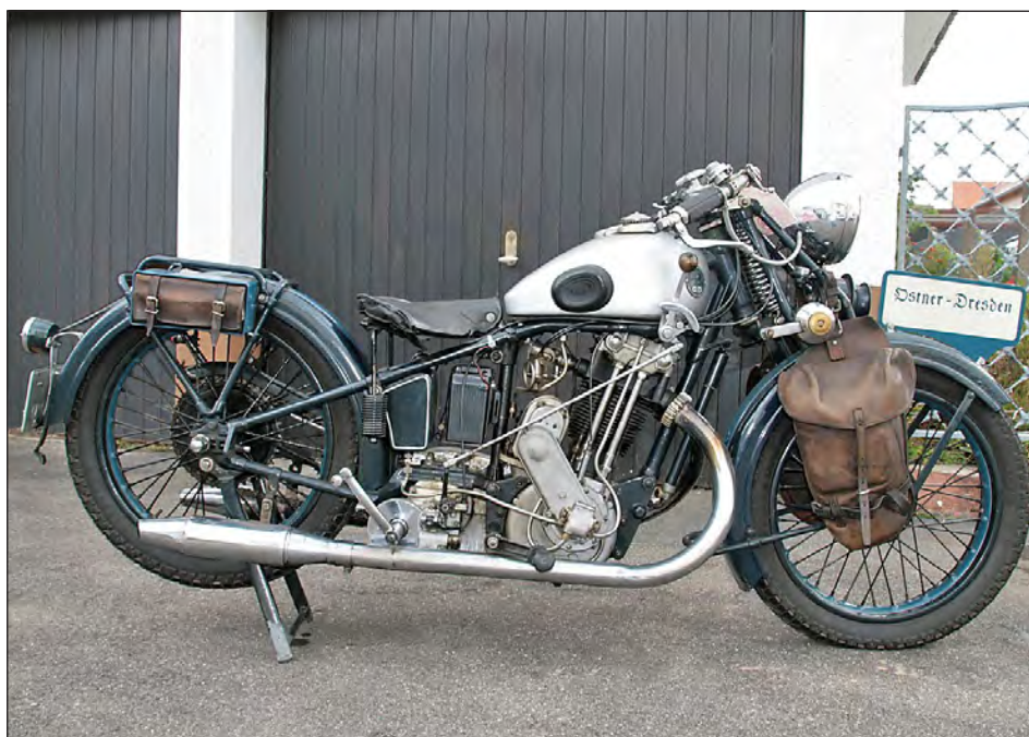
Der schräg eingebaute Einzylinder-Motor der Ostner Dresden hat eine Bohrung von 82 mm und einen Hub von 94 mm.
