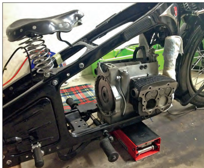
Erste Anprobe für den Motorblock im restaurierten Rahmen der Zündapp K800.
