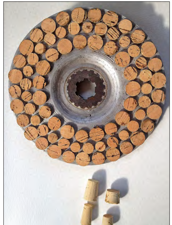
Einfache aber wirkungsvolle Lösung: Die Kupp- lung an Holger Achelpohls Zündapp ist mit Kork belegt.
