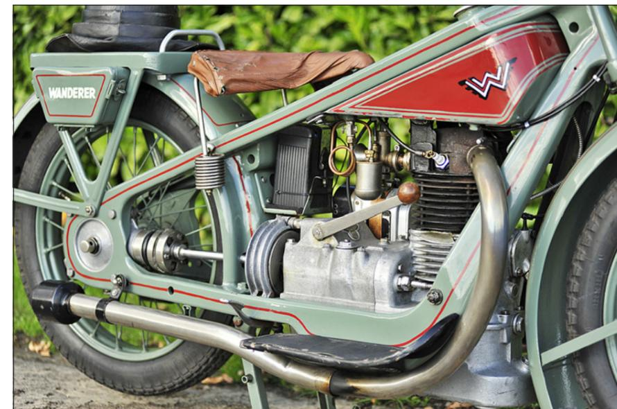
Die Kraft des stehenden Einzylinder-Motors mit seinen 500 ccm Hubraum wird zunächst auf das handgeschaltete Getriebe und dann mittels einer Kardanwelle auf das Hinterrad übertragen. Foto: Matthias Mausolf
