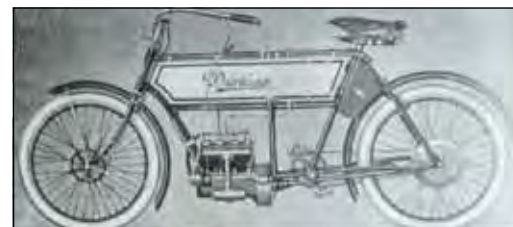
Die Zeichnung von 1905 zeigt es: Diese Dürrkopp hatte nicht nur einen Vierzylinder-Reihenmotor sondern auch schon einen Kardantrieb. Bild: Wikipedia
