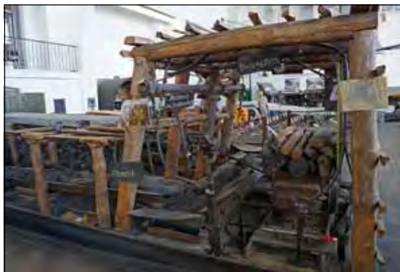
Macht mächtig Krach: Der Druckluftbohrer zum Erstellen von Sprenglöchern.
