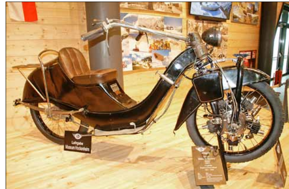
Sicherlich die abenteuerlichste Konstruktion bei Motorrädern: Die Megola mit ihrem Fünf-Zylinder-Sternmotor im Vorderrad. Gestartet wird er durch einen Tritt in die Speichen des Vorderrades. Dieses Fahrzeug haben wir im sehr sehenswerten Motorradmuseum auf dem Timmelsjoch (zwischen dem Ötztal in Tirol und dem italienischen Meran) fotografiert. Foto: Gregor Mausolf
